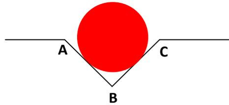
兩個相同圓球，一個沿平的斜面，另一沿相同傾斜、左右對稱的 V 形凹坑 (chute) (上圖紅球) 滾下。V 形凹坑的最低點 B 在球的中心正下方。
