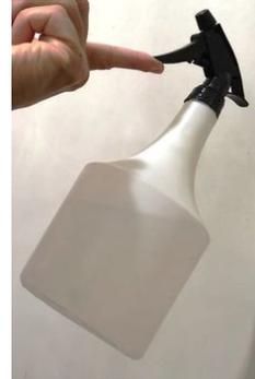
物體停止擺動之後，它的重心 ( c.g. ) 必在支點的正下方某處。
